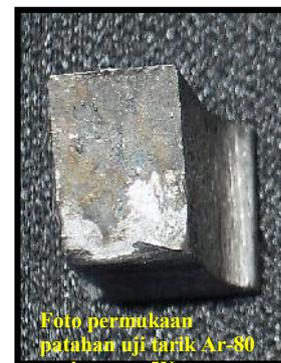
Gambar 10. Foto patahan permukaan uji tarik.
